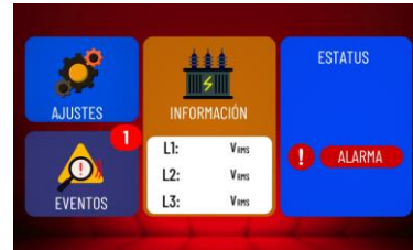
Estatus protección inactiva (reemplazo de spd)
